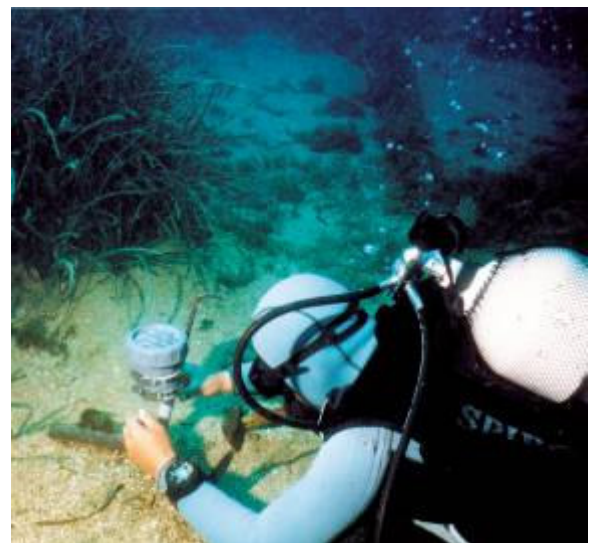
Figure 1 : Installation de la sonde thermique. Photo : F. Bachet/PMCB
